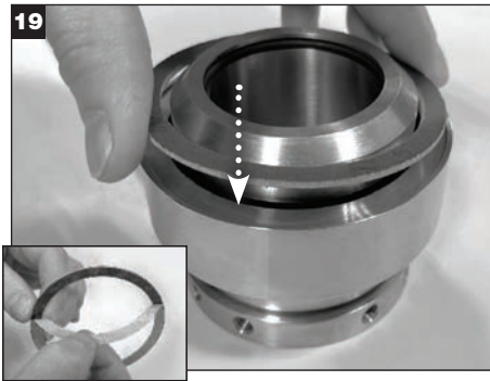
Desprenda el respaldo adhesivo de la junta de la brida e instálelo en hueco de la junta de la brida.
